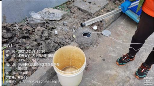
地下水井采样前洗井
