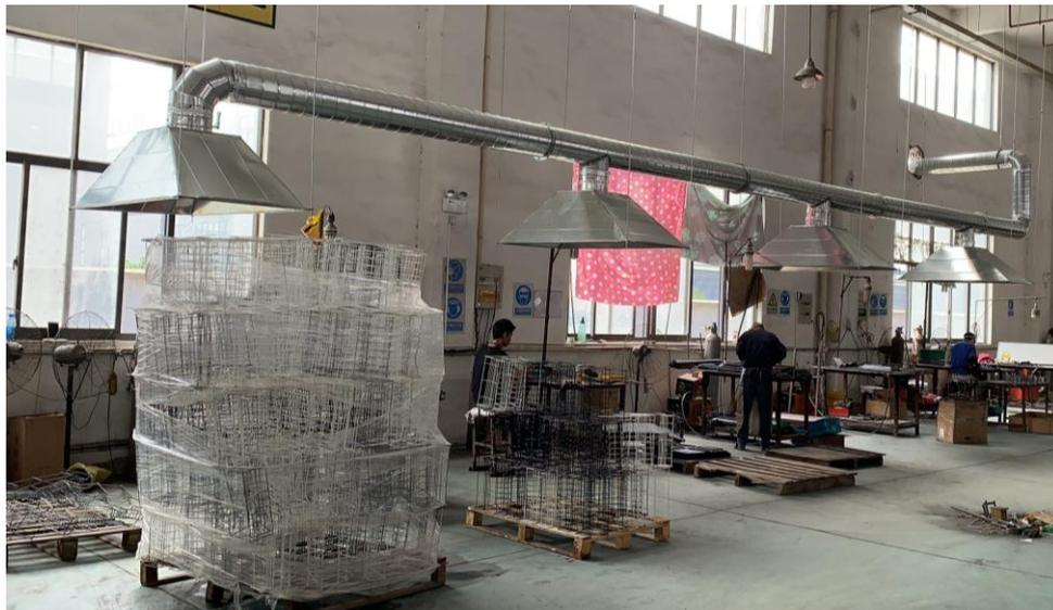
图 3-2 本项目金属颗粒物过滤处理装置图
