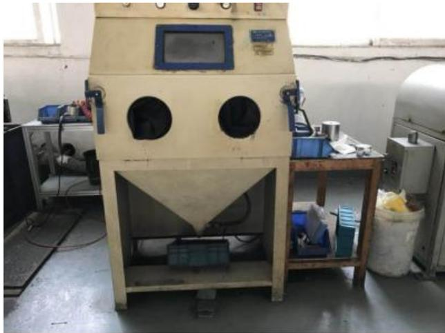
图 2: 喷砂机现场照片图
