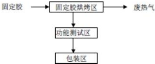
图2 集成电路IC测试生产工艺流程
