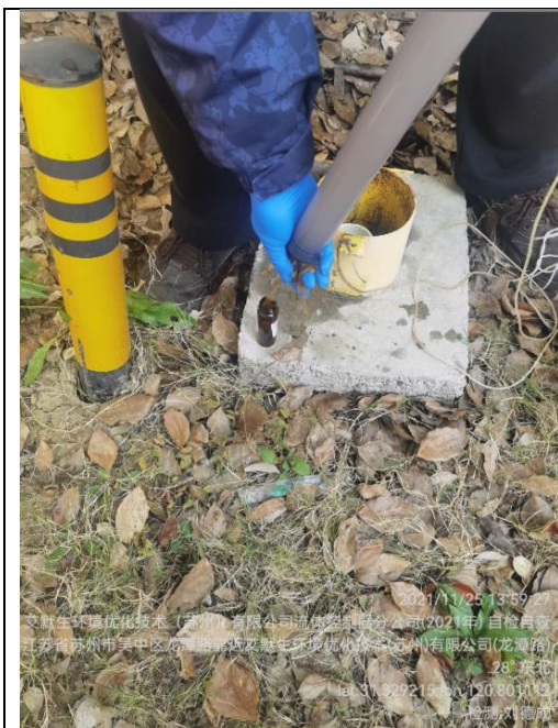
地下水VOCs采样
